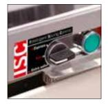
ISC: Intelligent Slicing Control (brevet JAC) Système de gestion automatique permanent de la coupe du pain. Permet une coupe régulière indépendemment de la consistance du pain.
